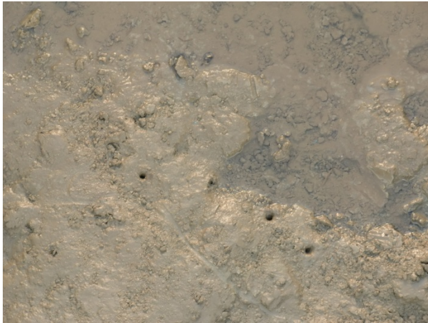
Figuur 6: Vermoedelijke wormgaatjes in de deklaag op MV -0,7 m
