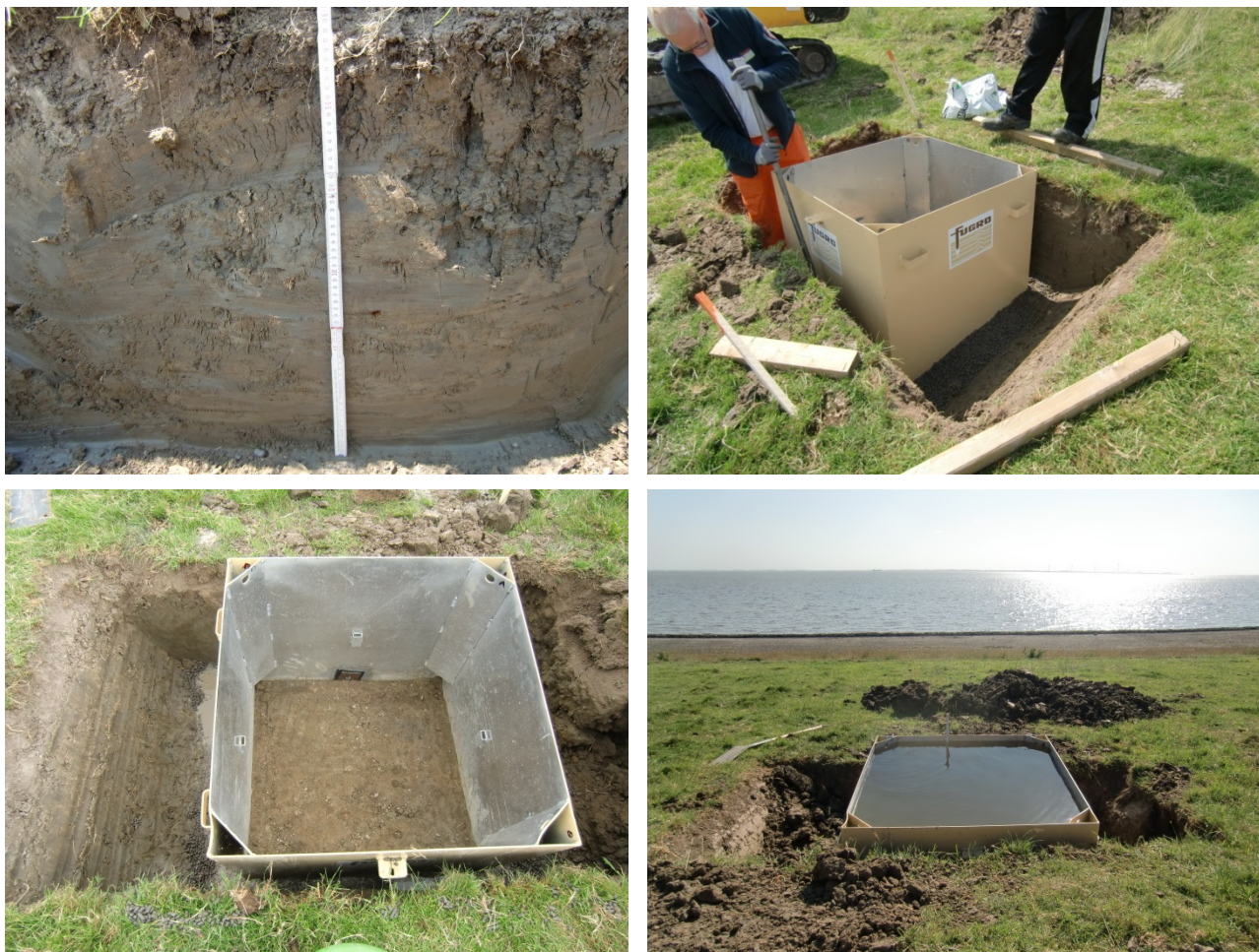
Figuur 4: Linksonder: doorsnede van de deels afgegraven deklaag; rechtsboven: installatie van de infiltratiebak; linksonder: opgeruwde bodem in de infiltratiebak; rechtsonder: bak volledig gevuld: start 2 o proef
