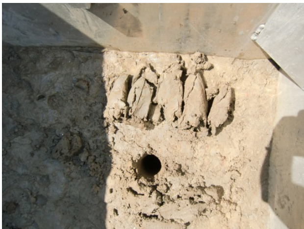
Figuur 7: Handboring in de infiltratiebak (HB6C)
