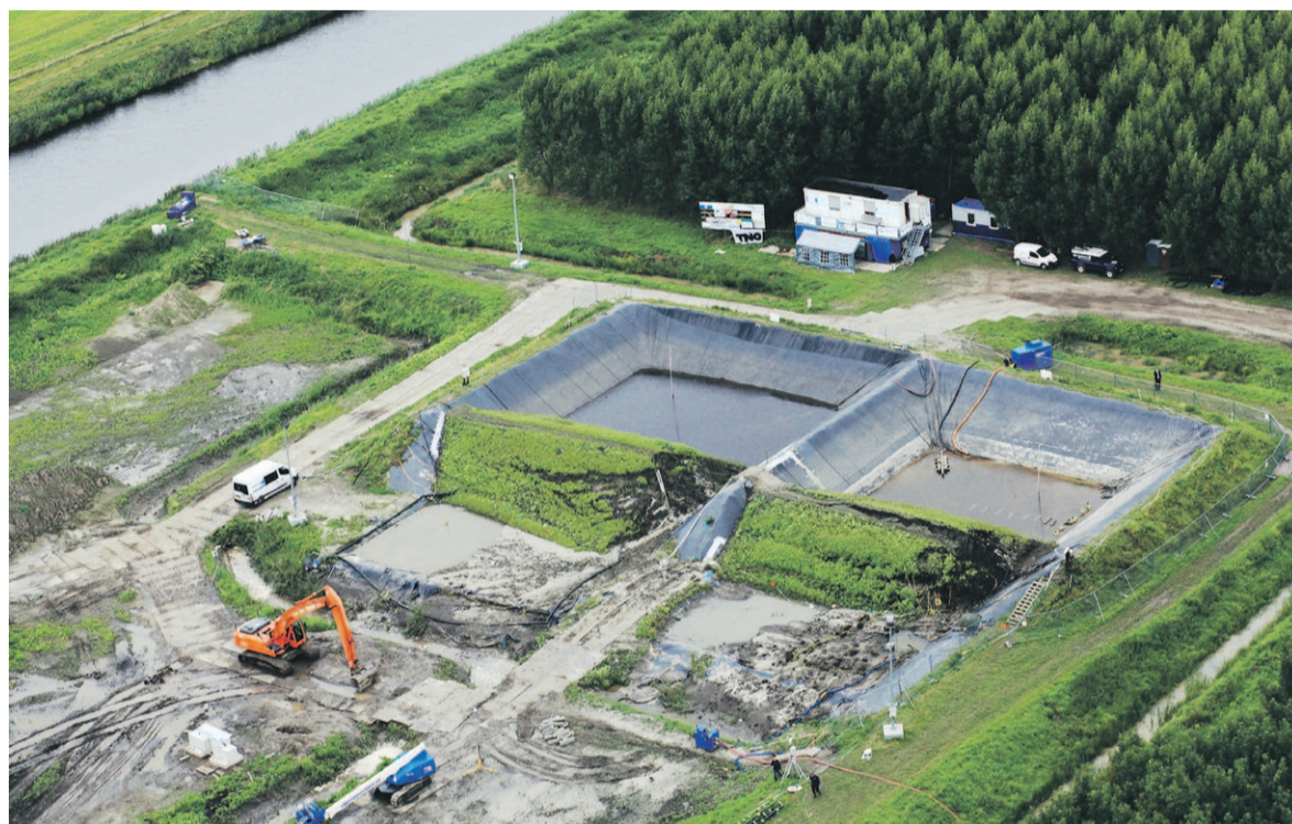
Situatie nadat beide dijken zijn bezweken op micro-instabiliteit. Foto's: Koos Boertjens
