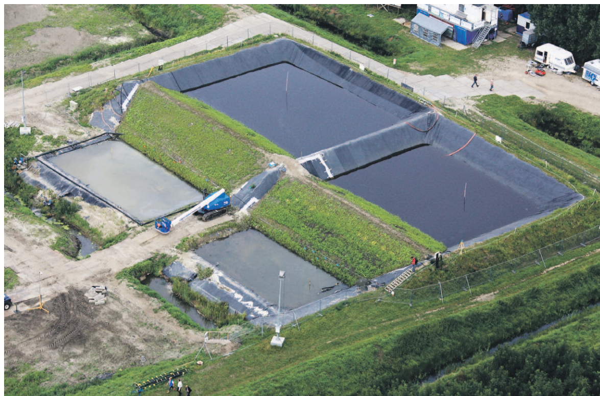
De proefdijken en waterbassins op het IJkdijkterrein kort na het begin van de proef.
